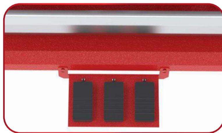
Зафиксируйте трафарет с помощью системы фиксации нажатием педали
