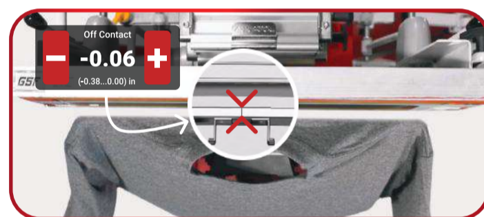
Цифровая регулировка off-contact с сенсорной панели управления
