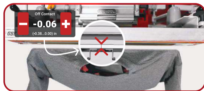
Цифровая регулировка off-contact с сенсорной панели управления
